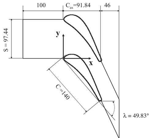
Fig. 1. Cascade dimensions (mm).
