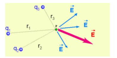
$$\vec{E}_{tot} = \vec{E}_1 + \vec{E}_2 + \vec{E}_3 + \dots \dots \vec{E}_N$$
