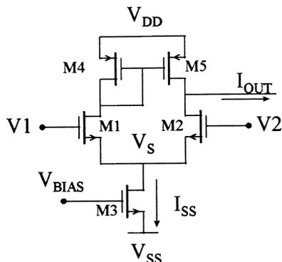
Fig. 1. The LTP CMOS transconductor.
