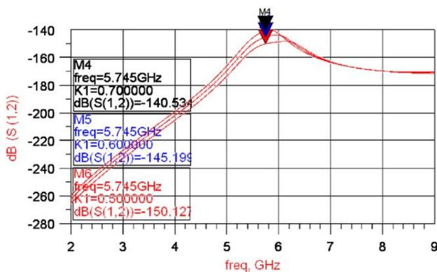
Fig. 8. Reverse isolation of the LNA.
